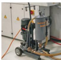
**ÖL-FILTER.** Das verwendete Hydraulik-Öl wird kontinuierlich auf Verunreinigungen geprüft. Bei Abweichungen wird das Öl gefiltert und kann danach weiterverwendet werden. Durch diesen Prozess fällt wenig Altöl an.
