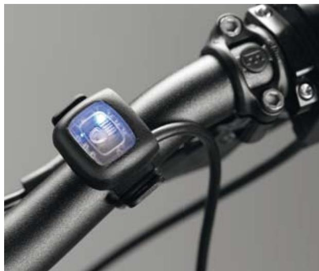
Der Lenker-Taster mit Kontroll-LEDs. Steuert die Licht-Features per Knopfdruck. Hier kann das USB-Kabel andocken.
