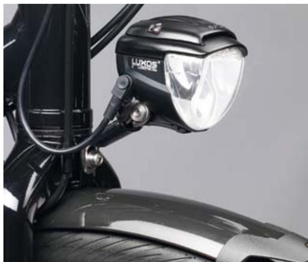
Der LUXOS E für „schnelle“ E-Bikes mit zwei Schaltstufen 60/120 Lux. Gedoppelte Kühlkörper-Einheit - die Oberfläche ist mattschwarz.
