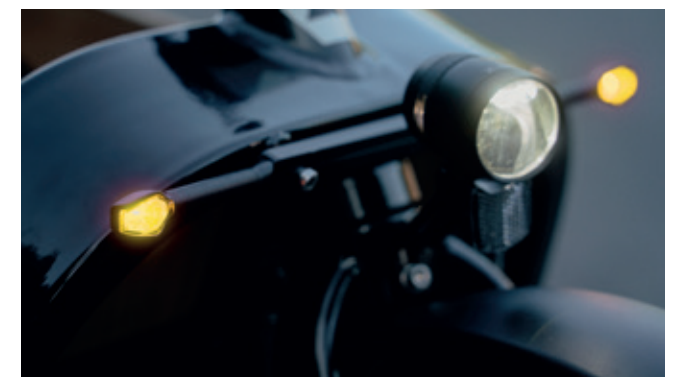
Montage an einem Cargo-Bike. Mindestabstand zwischen den Blinkern beträgt 24 cm.
