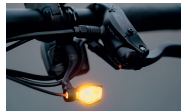
Lenkermontage für gute Sichtbarkeit von vorne.
