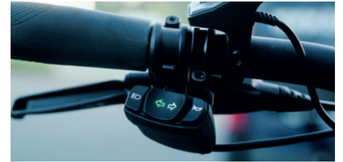
Schalter mit Funktionsanzeige, intuitiv zu bedienen.
