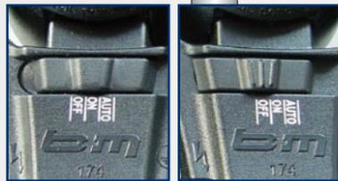
Der Unterschied beim LUMOTEC IQ Fly: rechts der Schalter mit Riffelung auf dem Griff – das Zeichen für abschaltbares Standlicht
