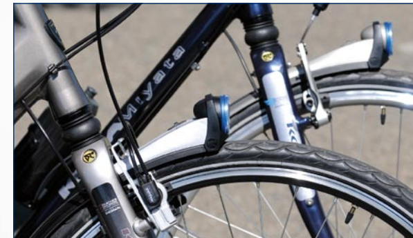
„Rayo“ heißt die Scheinwerferentwicklung von Koga Myata mit IQ-TEC. Ins Schutzblech integriert und nach vorne gezogen, sitzt der verstellbare Scheinwerfer „in der ersten Reihe“ und wirkt optisch sehr souverän.
