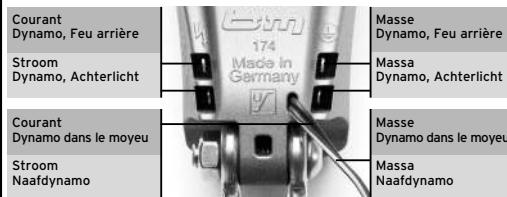
Voor het aansluiten op de naafdynamo moet de voorgemonteerde dubbele kabel worden gebruikt. Kabel niet afsnijden, alleen op de benodigde lengte inkorten. Niet de op de fiets voorhanden dynamokabel gebruiken. Het achterlicht moet op de stekcontacten op de koplamp worden aangesloten.
